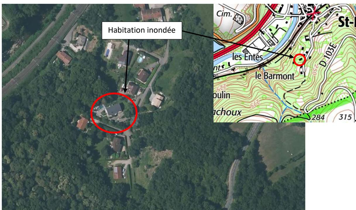
Aucun réseau de collecte des eaux pluviales ne dessert ce secteur du Barmont. Les eaux pluviales de la voirie à l'amont de l'habitation sont collectées par un fossé puis canalisées un faible linéaire (quelques mètres). Cette canalisation rejoint ensuite un caniveau traversant la propriété inondée. D'après la commune, le fossé et sa partie busée connaissent des défauts d'entretien (curage nécessaire).
