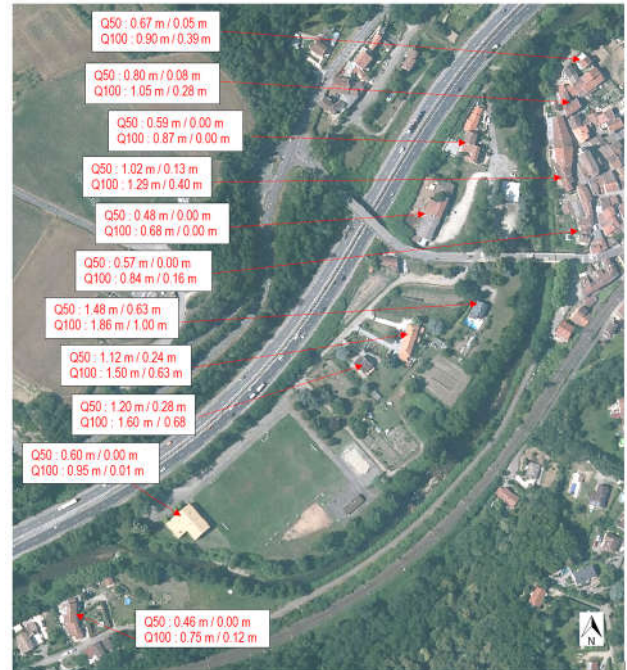
Comparaison des cotes de crues cinquantennale et centennale à l'état actuel et à l'état projet (Hauteur d'eau à l'état actuel / Hauteur d'eau à l'état projet)
