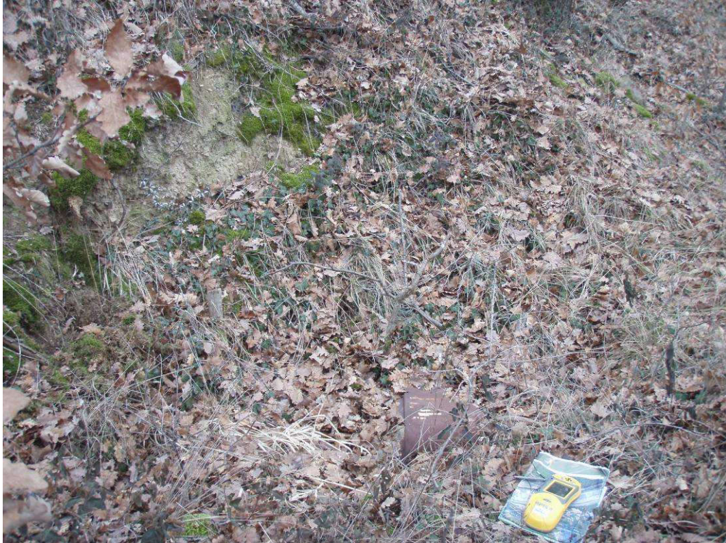
Photo 14 : fontis du puits de l'Espérance (concession de Givors et Saint-Martin de Cornas).
